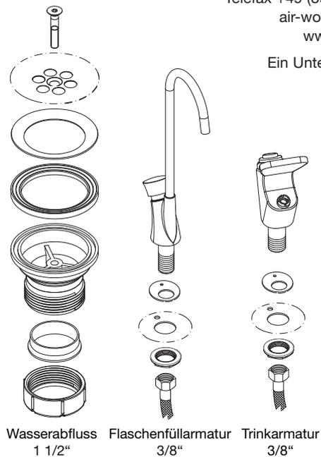
Wasserabfluss 1 1/2" Flaschenfüllarmatur 3/8" Trinkarmatur 3/8"
